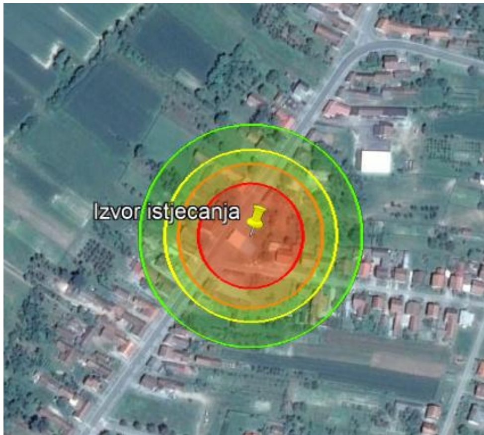
Slika 7. Zone ugroženosti uslijed istjecanja cjelokupne količine benzina i nastanka požara
