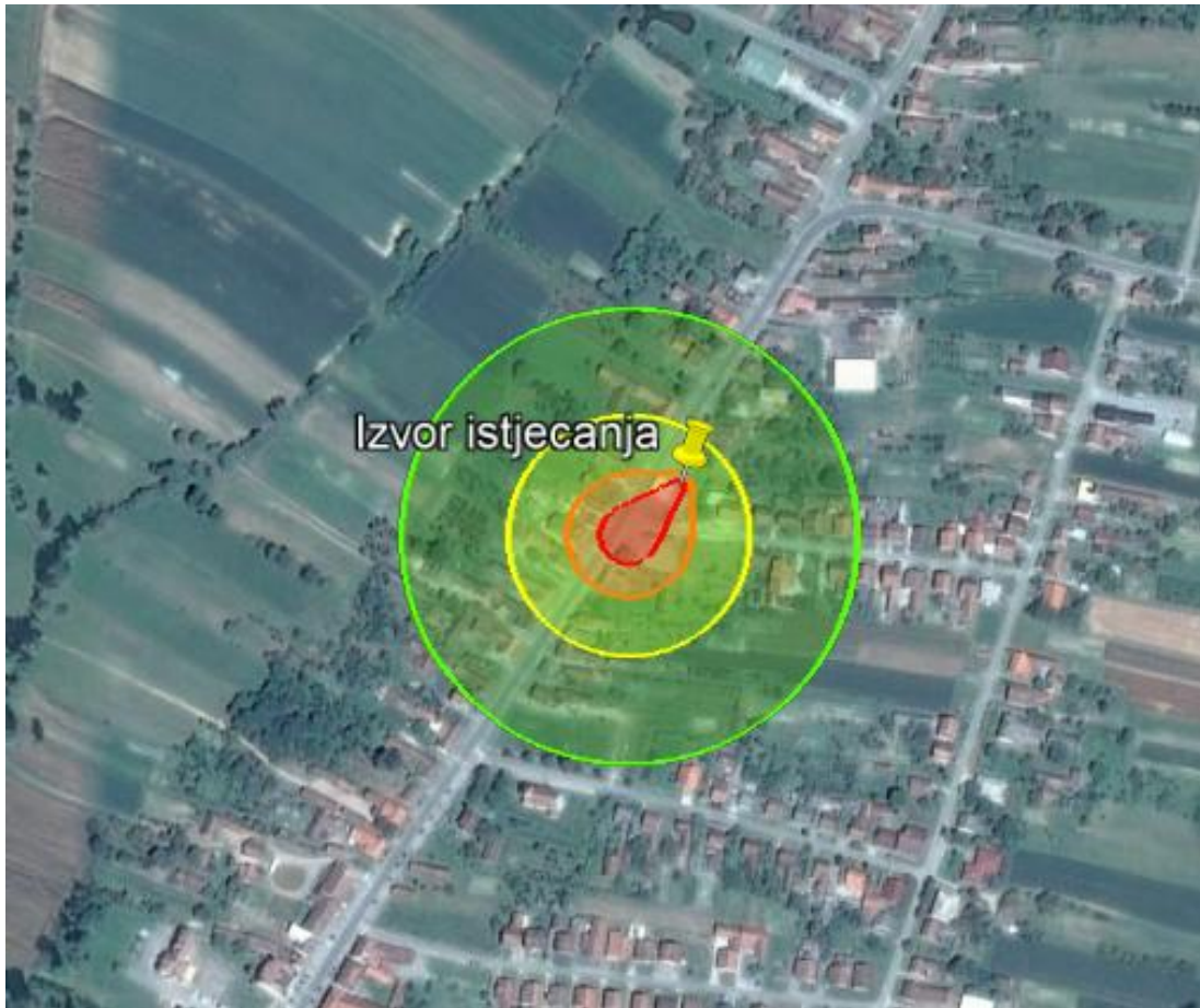
Slika 6. Zone ugroženosti eksplozije plinovite faze benzina
